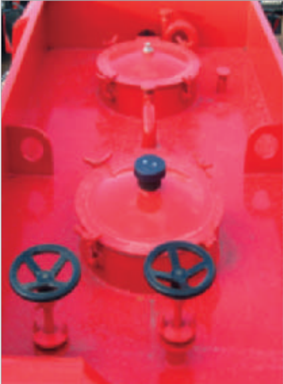
CISTERNA MULTIFUNCIÓN VARIOS COMPARTIMENTOS. EMULSIÓN + AGUA + GAS-OIL
