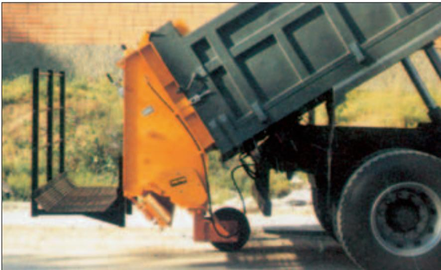
Plataforma del operario de 40 cm de ancho de fácil acceso, equipada con barandilla de seguridad y piso antideslizante, abatible para el transporte y sin cadenas de sujeción.
