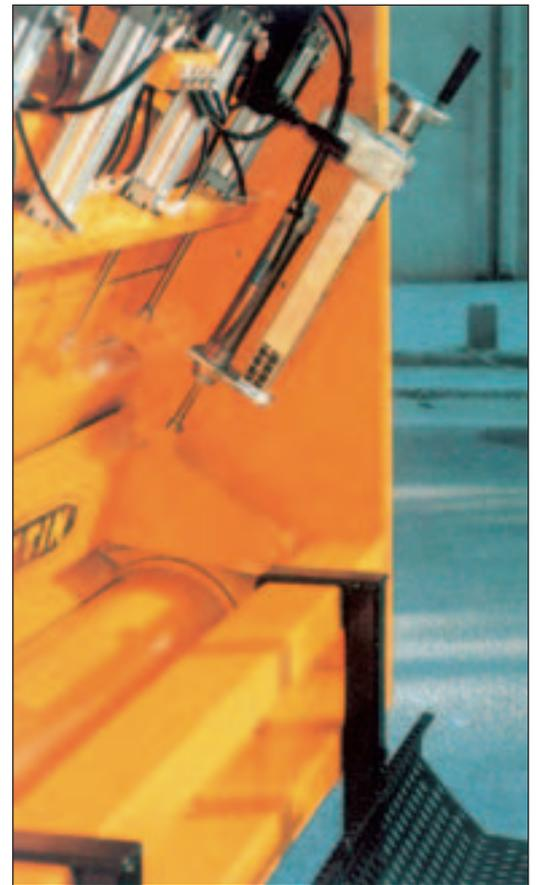
Cilindro neumático para el accionamiento de la compuerta general de dosificación.
