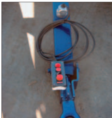
Mando a distancia para puesta en marcha y actuación barrido.
