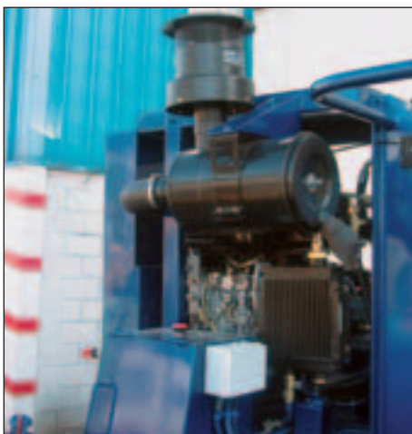
Filtro aspiración aire y refrigerador aceite hidráulico independiente.
